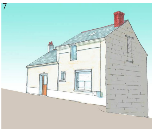
Figure 207 : L'ajout d'une petite fenêtre à barreaudage - (AB - architecte)
