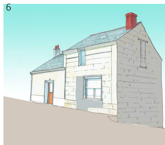
Figure 206 : Le remplacement de la porte et de la fenêtre du rez-de-chaussé par une grande baie au proportions inadaptée - (AB - architecte)
