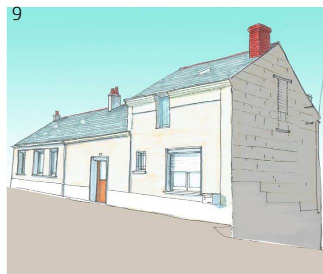
Figure 209 : Une deuxième extension avec des fenêtres aux proportions et aux matériaux inadaptés - (AB - architecte)
