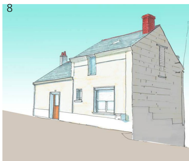
Figure 208 : Un enduit ciment en bas de mur pignon et des câbles électriques disgracieux - (AB - architecte)
