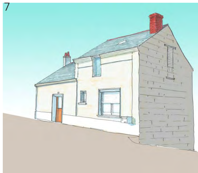
L'ajout d'une petite fenêtre à barraudage
