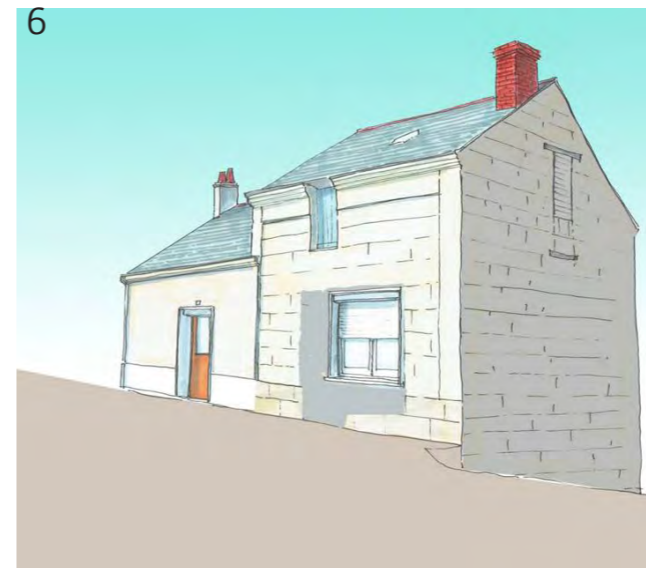
Le remplacement de la porte et de la fenêtre du rez-de-chaussé par une grande baie au proportions inadaptée
